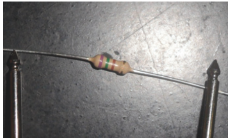
Figura 3. Medição de componentes fora do circuito.
