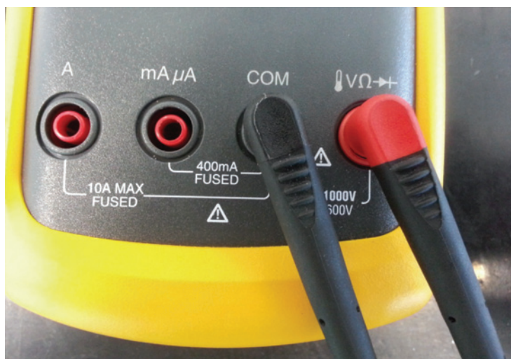
Figura 6. Ligação correta dos cabos das pontas de prova. ●
